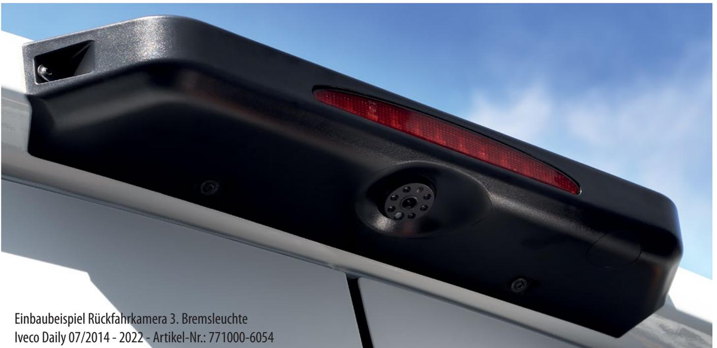
Einbaubeispiel Rückfahrkamera 3. Bremsleuchte
