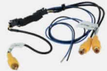
Interface zum Anschluss und Umschalten von zwei Videoquellen an einen Videoeingang. Umschaltung durch ein geschaltetes +12V Triggersignal. Anschluss von Dual View Kameras an Geräte und Monitore mit einem Videoeingang
