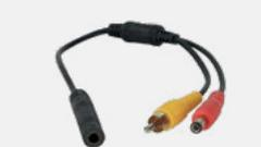
Dieses Kabel ermöglicht es, Kameras aus dem acv Programm Plug & Play mit acv Monitoren zu verbinden. Diese werden somit direkt aus dem Monitor bestromt und müssen nicht mehr separat mit Strom versorgt werden. Bei 24 Volt Fahrzeugen können alle acv Kameras somit direkt über den Monitor mit 12 Volt versorgt werden, da alle 24Volt geeigneten acv Monitore über einen integrierten Spannungswandler verfügen
