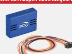
Interface zur Erzeugung von erforderlichen analogen Triggersignalen für die Installation von Multikamerasystemen. Durch den zentralen Abgriffspunkt der Signale im Fahrzeug entfällt eine zeitaufwändige Verkabelung und die Montagezeit wird verkürzt. Es werden Rückfahrsignal, Blinker links, Blinker rechts und +12V Klemme 15 aus dem CAN-Bus System ausgelesen und analog zur Verfügung gestellt.
