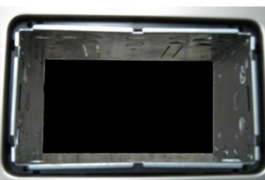
Fit the double din metal bracket.
