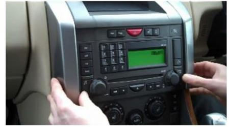
Lösen Sie Umrandung mit einem geeigneten Werkzeug.
