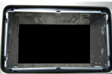
Montieren Sie den Doppel Din Rahmen in die Radioblende
